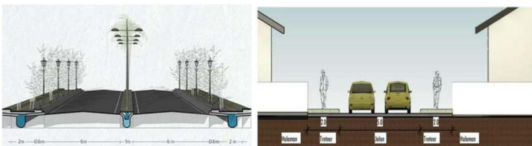
Gambar 3. (a) Potongan Jalan Primer, (b) Potongan Jalan Sekunder
