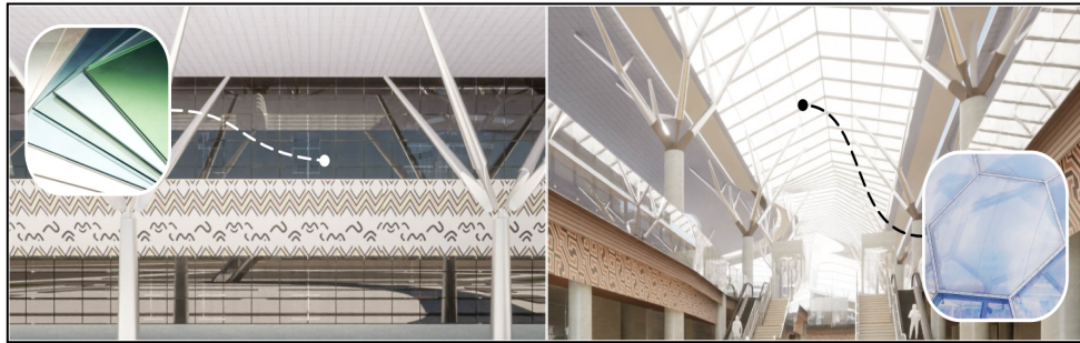
Gambar 8 Penerapan material glazing Kaca Low-E (kanan) dan ETFE Low-E (kiri) Sumber: Penulis, 2023
