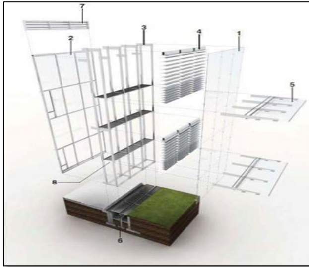
Gambar 3. Ilustrasi komponen pada double-skin facade dengan material kaca
