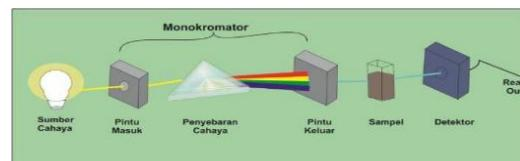
**Gambar 2.2** Skema komponen spektrofotometer UV-VIS (Erick, 2018)
