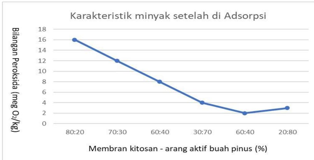
Gambar 5. Penurunan bilangan peroksida dengan menggunakan adsorben membran kitosan - arang aktif buah pinus
