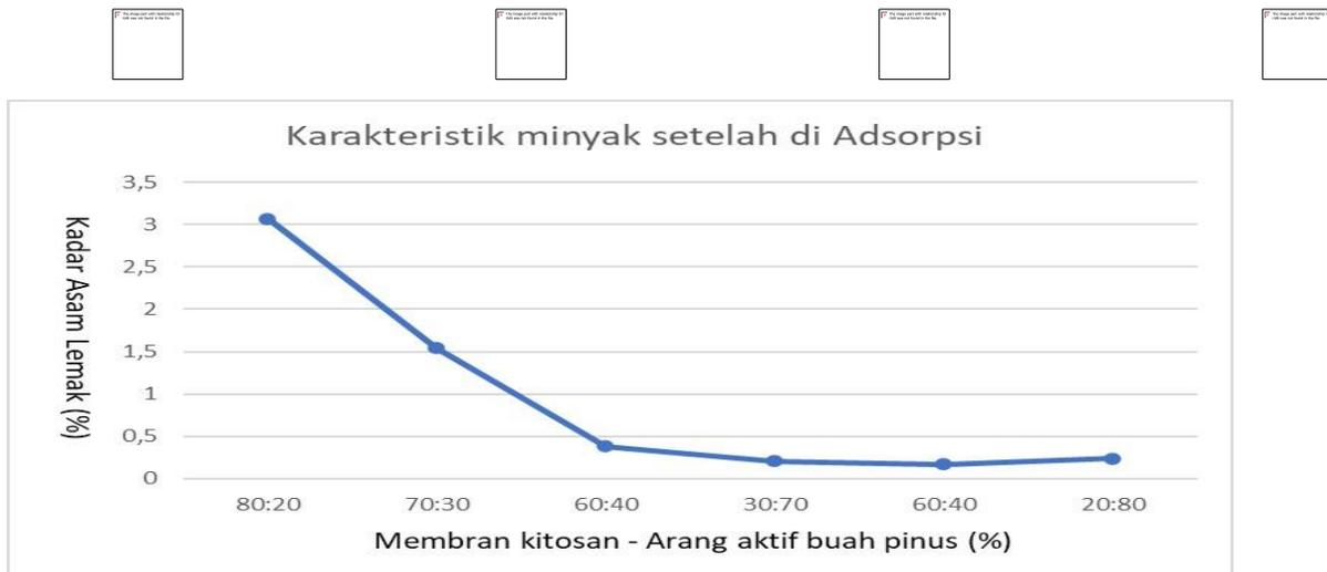
Gambar 4. Penurunan kadar asam lemak dengan menggunakan adsorben membran kitosan - arang aktif buah pinus
