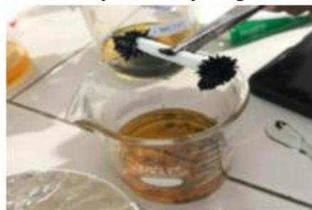
Gambar 4.2 Gumpalan Serbuk Besi Setelah Bereaksi dengan Sulfur
