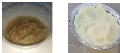
hasil proses delignifikasi , hasil bleaching Gambar 4.3: hasil ekstrak selulosa dari proses delignifikasi dan proses bleaching
